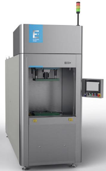
Die ECO+ für die elektrochemische Oberflächenbearbeitung ist ideal für kleine bis mittlere Volumina
